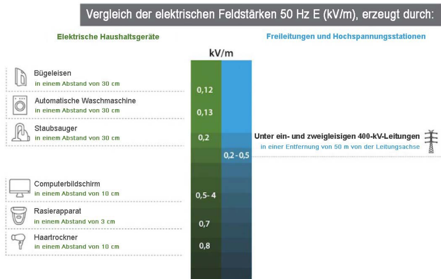
Abbildung 31 | Vergleich der elektrischen Feldstärken bei 50 Hz (kV/m), die von elektrischen Haushaltsgeräten und Höchstspannungsfreileitungen erzeugt werden (Quelle: http://budowalinii400kv.pl/ ).
